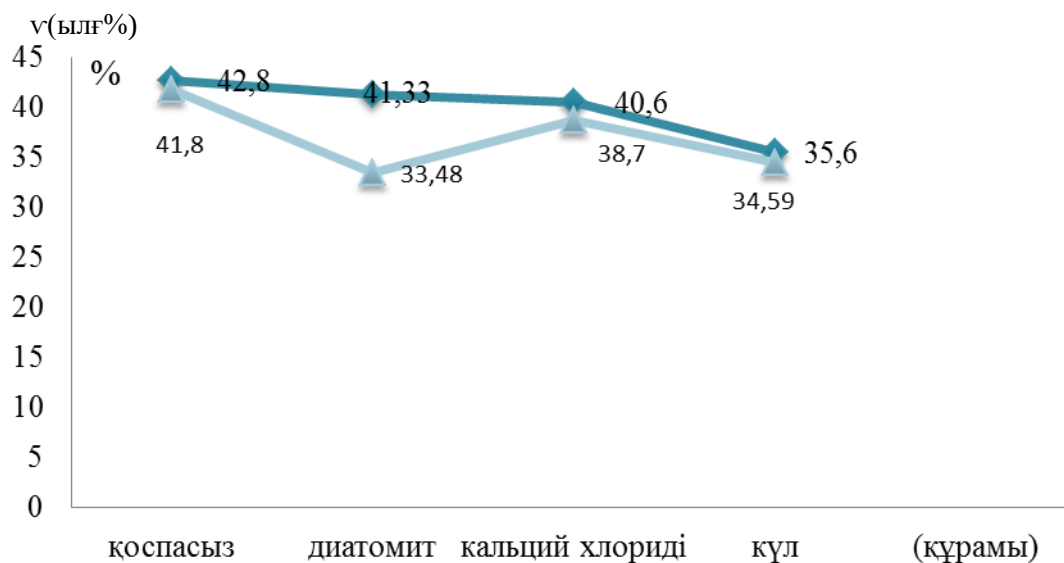
1 сурет – көбікті бетонның ылғалдылығы көрсетілген қисық сызық
